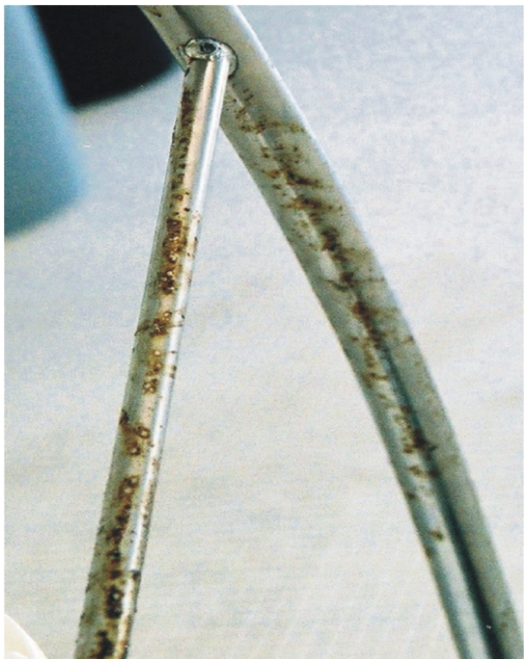
图4 用于固定泳道标志的镀铬碳钢卷盘投入使用仅几年，镀层下就已严重锈蚀。 供图/TMR咨询公司
