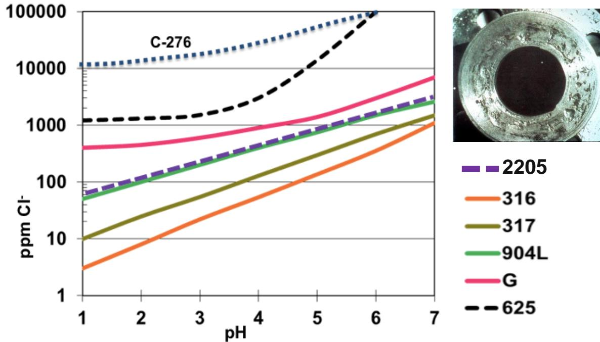
但是该图 ( $T_{\text{最大}}=60^{\circ}\text{C}$ , 中等氧化电位) 未能准确描述高氧化条件下, 特别是锰的存在金属表面形成缝隙的情况。
