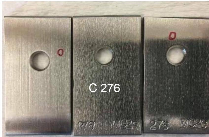
只有15%钼合金的表面浸蚀可忽略不计，而且没有明显的重量损失。
